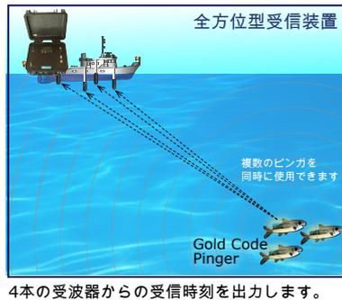
4本の受波器からの受信時刻を出力します。PCを接続して出力された到達時間の差で方向を計算できます
