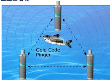
複数設置した受信機に記録されたピンガの情報から測位計算を行うことができます
